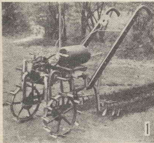
Un piccolo motore elettrico adatto per esterni aziona questo coltivatore costruito con parti di ricupero, per una spesa assai bassa.
